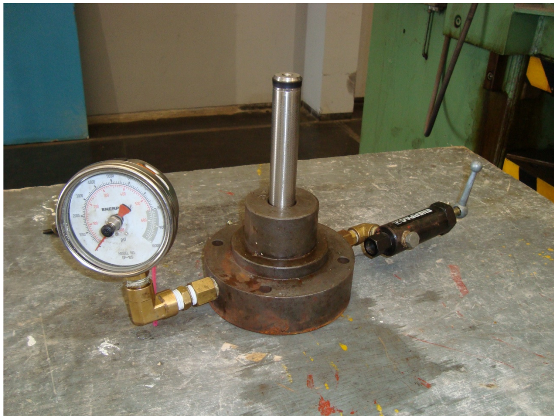
Figura 4.2. Matriz inferior e um dos tubos utilizados nos ensaios.
