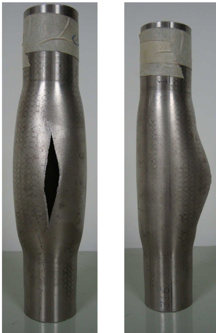
Figura 6.1.4. Tubo levado até o nível de pressão de ruptura (63 MPa).
