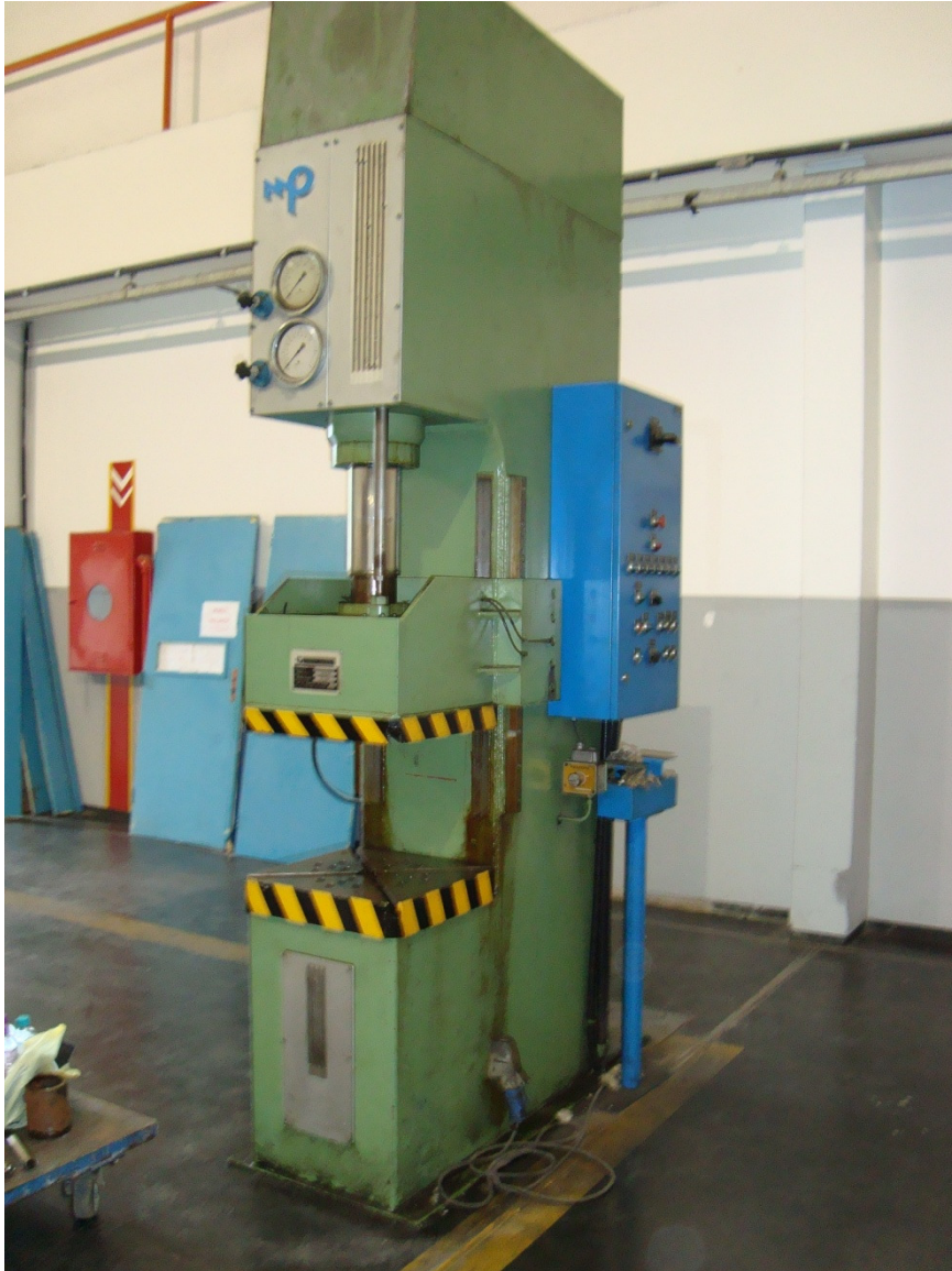
Figura 4.3. Prensa hidráulica de 300kN (30 ton.) da Oficina de Fabricação Mecânica da EPUSP.
