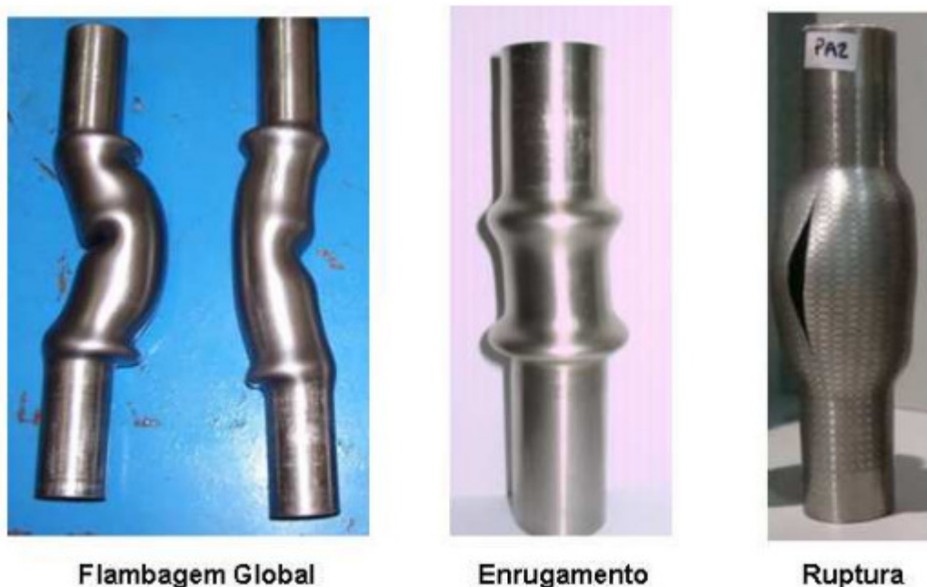
Figura 1.2.6. Modos de falha para tubos durante o processo de hidroconformação (ABRANTES, 2009).
